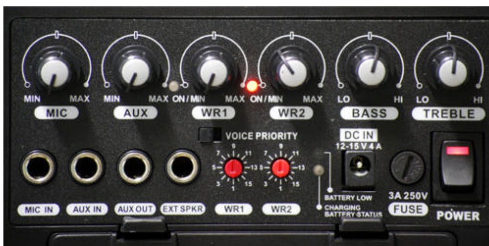
Particolare del pannello comandi e presa ingresso alimentazione ( fig. 1)
